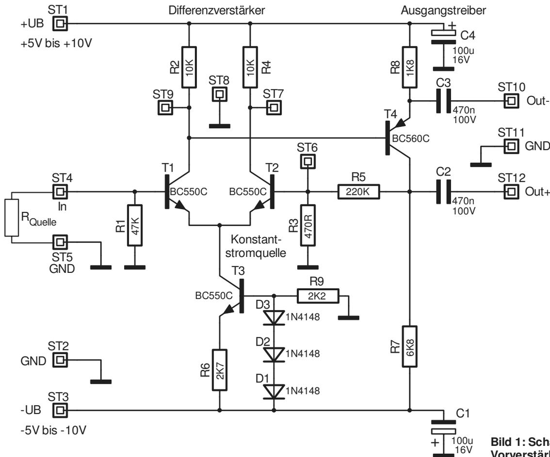
**Bild 1: Schaltbild des Mikrofon-Vorverstärkers**
