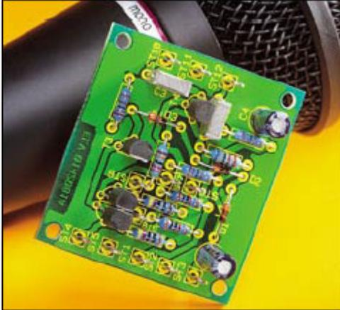
**Mikrofon-Vorverstärker für dynamische Mikrofone in bewährter Transistortechnik mit hoher Verstärkung und besonders geringem Eigenrauschen.**
